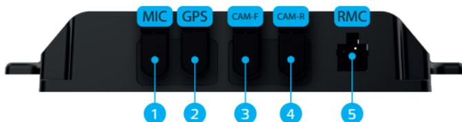
1. Разъем для подключения микрофона
